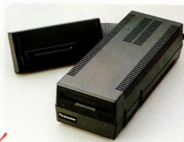
**Diskettenlaufwerk** zur Speicherung größerer Datenmengen (3", 180 KB). Das erste Laufwerk wird mit Steuer-einheit CP/M und LOGO geliefert.
